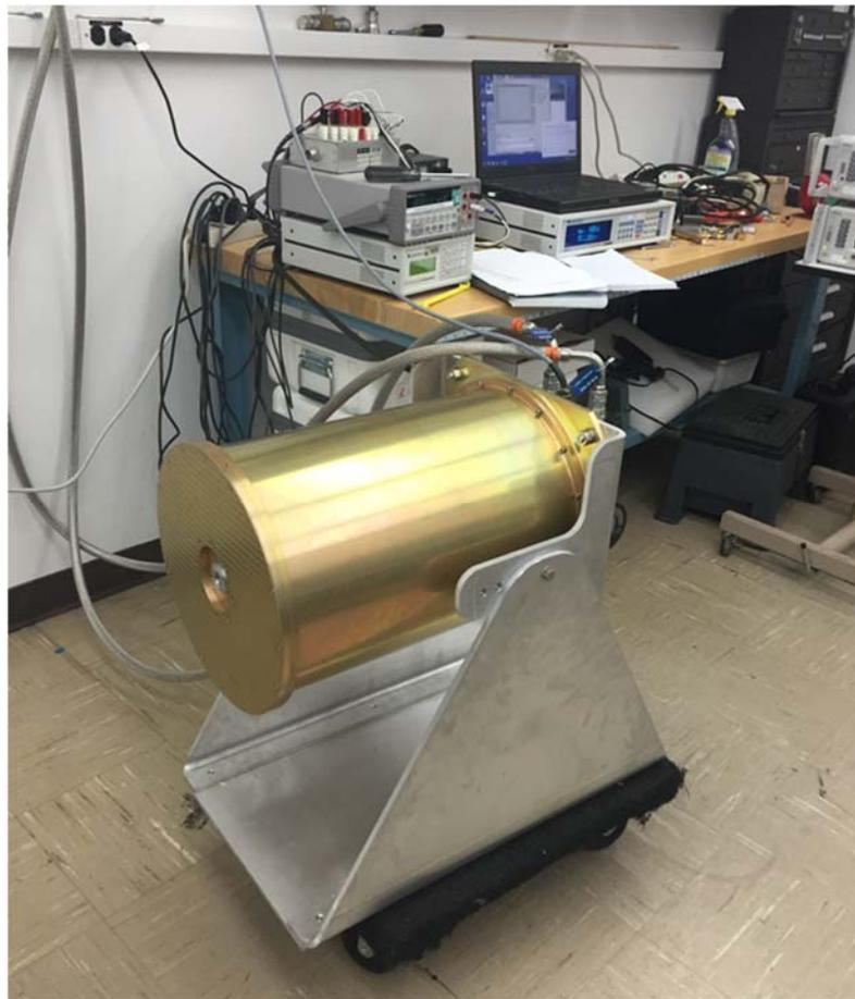
**Figure 4. Cryostat on tilt-test gimbal.**
